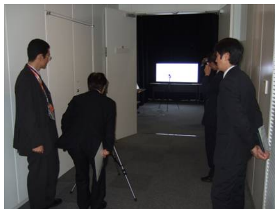
写真 2-2 大型BOX(ネオン)の輝度測定
