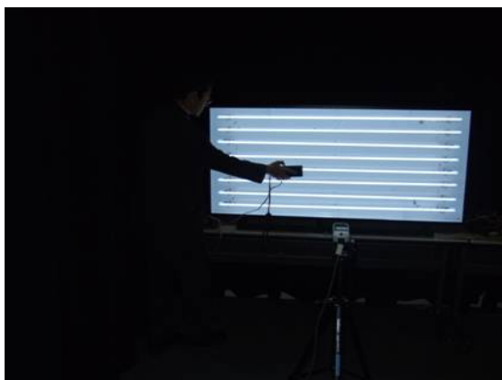
写真 2-1 大型BOX(ネオン)の照度測定
