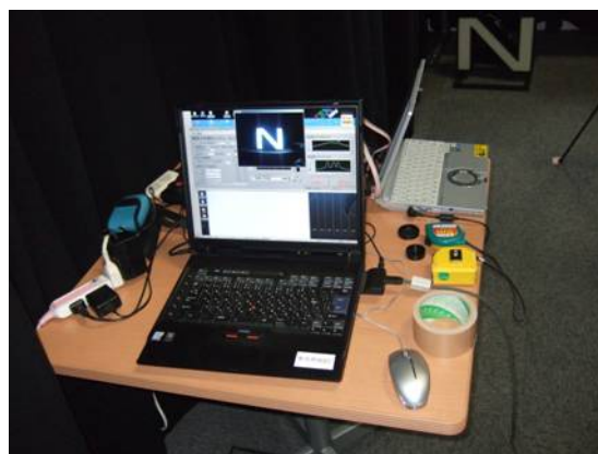
写真 2-6 中型N文字(ネオン)の輝度測定画面
